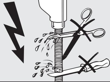
⚠ Stromschlaggefahr durch Netzspannung.
