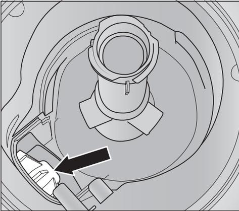
Unter der Abdeckung befindet sich die Ablaufpumpe (Pfeil).
